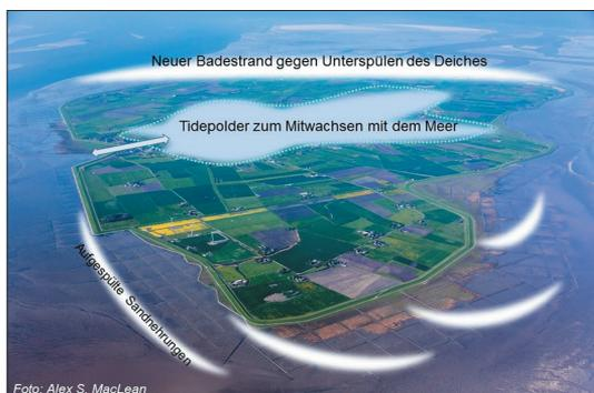
**Abb. 5.4-6:** Anpassungen für die Insel Pellworm an den steigenden Meeresspiegel, die gleichzeitig den Tourismus fördern. Ein aufgespülter Badestrand im Westen (im Luftbild oben) schützt den Deich vor Unterspülung. Aufgespülte Sandhaken lösen Landgewinnungsfelder ab und erhöhen die Biodiversität. Gezeitenabhängige Flutungen lassen die abgesackte Inselmitte wieder wachsen und ermöglichen neue touristische und aquatische Nutzungsformen (HENNE 2010 und siehe Text).
