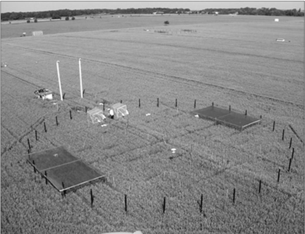
Abb. 4.6-1: Ansicht eines FACE-Ringes (Durchmesser 20 m) in einem Winterweizenbestand in Braunschweig im Juni. Innerhalb der Ringfläche ist die atmosphärische CO<sub>2</sub>-Konzentration auf 550 ppm erhöht. Teilflächen im Ring sind für physiologische Detailuntersuchungen beschatet bzw. für Bestandes-Photosynthesemessungen ausgerüstet.
