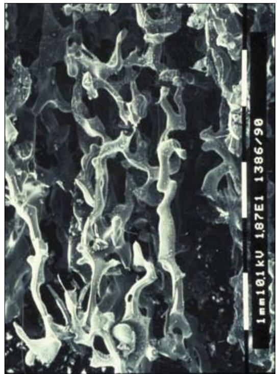
Abb. 3.3-1: Salzlaugenkanalsystem von säulig-körnigem Meereis als Kunstharzausguss unter dem Rasterelektronenmikroskop (WEISSENBERGER et al. 1992).
