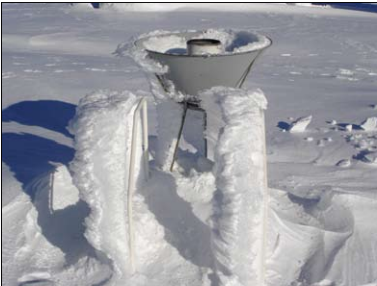
Abb. 4.2-1: Anschauliches Beispiel für die Problematik der Niederschlagsmessung unter extremen Bedingungen (DWD, Wetterstation Brocken. Photo S. Rösner, mit seiner freundlichen Genehmigung).
