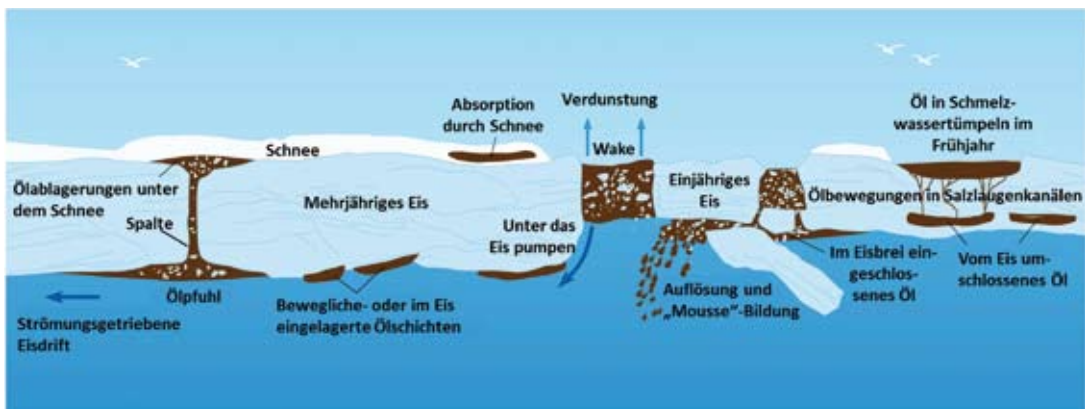
Abb. 5.7-3: Schematische Darstellung der vielfältigen Ablagerungsmöglichkeiten von Öl im meereisbedeckten Ozean und damit verbundene Prozesse (nach BOBRA & FINGAS 1986).
