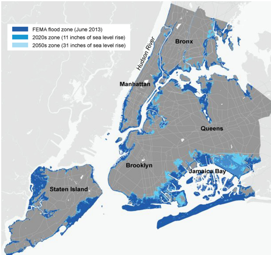
Abb. 3.2-6: Potenzielle Hochwassergebiete in NYC bei einem 100-Jahres-Hochwasser um 2010 (nach Einschätzung der Federal Emergency Management Agency, FEMA) sowie bei gleicher Wiederkehrperiode in den 2020er (bei einem zusätzlichen Meeresspiegelanstieg von 28 cm) und 2050er Jahren (bei einem zusätzlichen Meeresspiegelanstieg von 79 cm), verändert (KENNEDY 2014, public domain).
